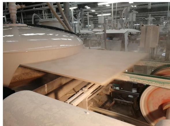
Figura 2.5 - Aplicação de vidro/esmalte
